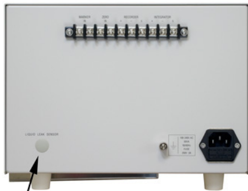
液漏れセンサー出力端子
